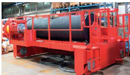
Jeřábová kočka při montáži ve společnosti GIGA
