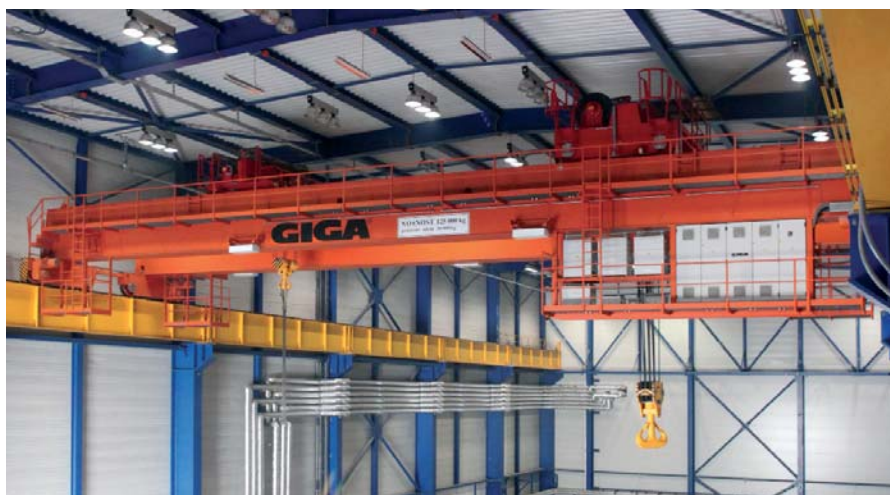
Dvounosníkový mostový jeřáb s kladkostrojí GIGA typ GDMJ 125t/30t/26m
