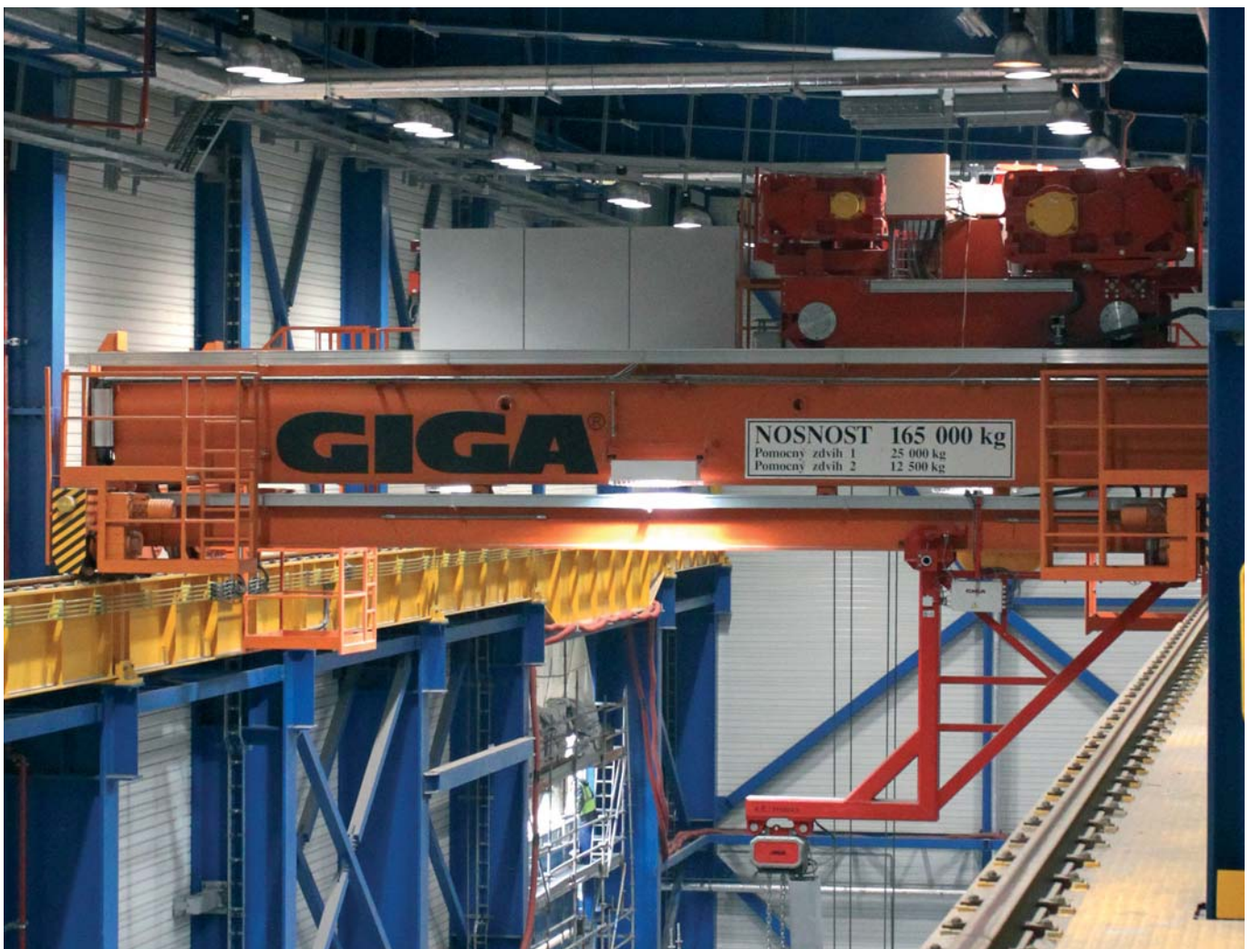
Dvounosníkový mostový jeřáb s kladkostrojí GIGA typ GDMJ 165t/25t/12,5t/11,5m
